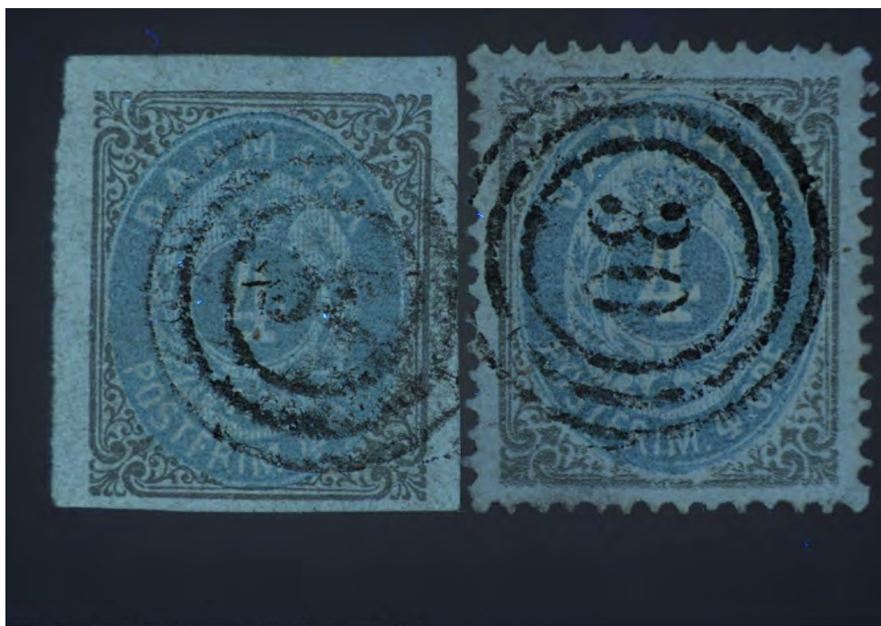
Figur 5. Koldingmærket til venstre (tryk 22 pos. B4 utakket) og et almindeligt takket mærke fra tryk 22 til højre. 365 nm UV lys fra oven i VSC8000HS maskinen fra Heinrich Köhler. Læg mærke til, at stempel-svæarten også i dette lys ikke afviger fra resten af mærket, og at papirfarven og papirteksturen er konstant over hele mærket og identisk med det takkede referencemærke.
